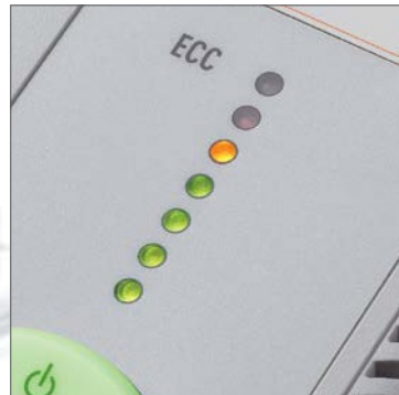
ECC - Electronic Capacity Control wskaźnik poziomu obciążenia urządzenia
