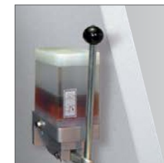
Standardowym wyposażeniem jest oliwiarka zapewniająca płynną pracę głowicy tnącej
