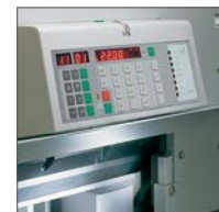
MODUŁ STEROWANIA ma m.in. pamięć o pojemności 99 programów, po 99 kroków każdy, kalkulator
