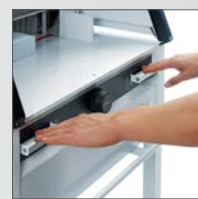
Oburęczne uruchamianie cięcia kontrolowane elektronicznie (EASY-CUT)
