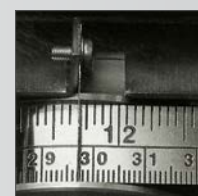
Taśma miernicza do odczytu odległości siodła od linii cięcia
