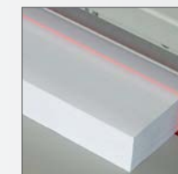
"Linia świetlna" pokazuje miejsce cięcia
